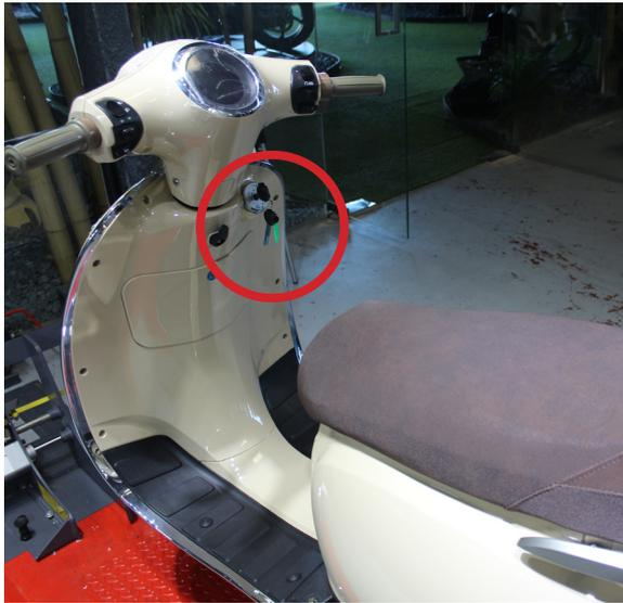
1. Para poder acceder a la batería del vehículo será necesario introducir la llave en la cerradura de arranque.
