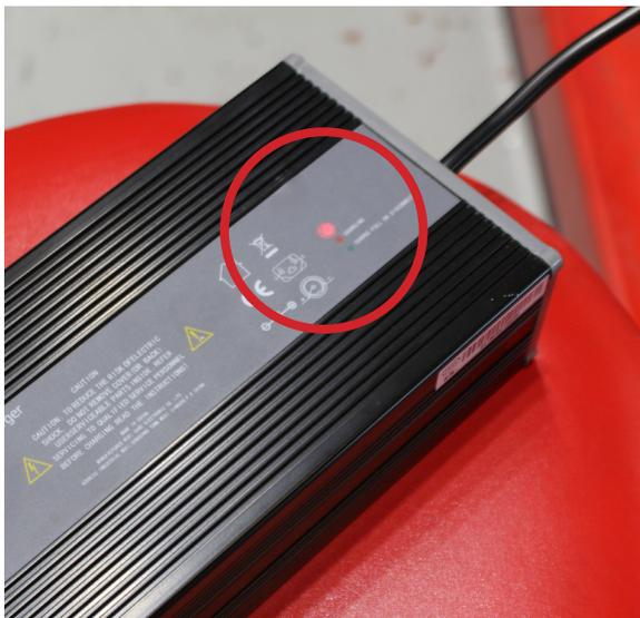
8. Esperamos un par de segundos y comprobamos que el led indicador del cargador ha cambiado a color rojo.
