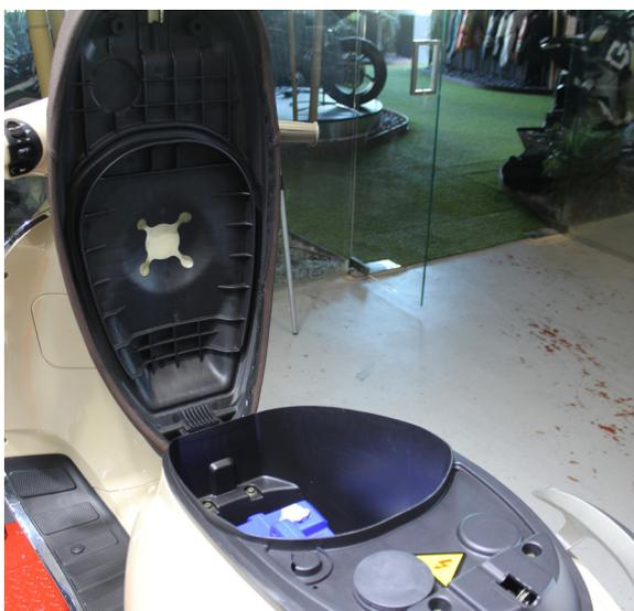
3. Levantamos el asiento para poder acceder a la batería y sus conexiones.
