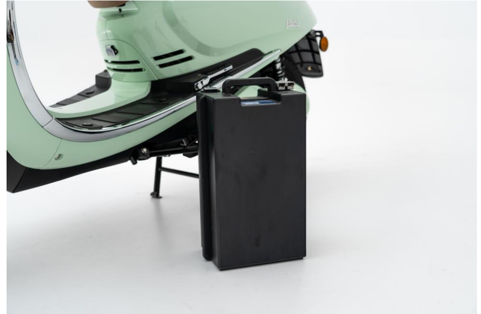
Batería una vez extraída
