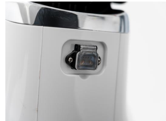
Toma de carga externa
